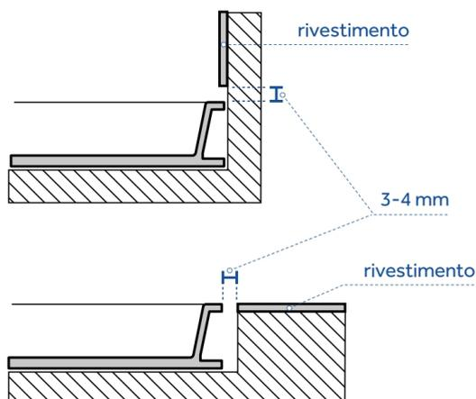
Allargare il piatto doccia tenendo conto dello spessore del rivestimento a parete (o al suolo in caso di installazione filo pavimento) e lasciando uno spazio di 3-4 mm.
