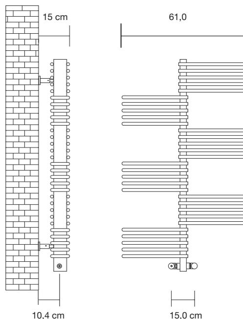
Interasse attacchi con misure riferite alle valvole Tubes
