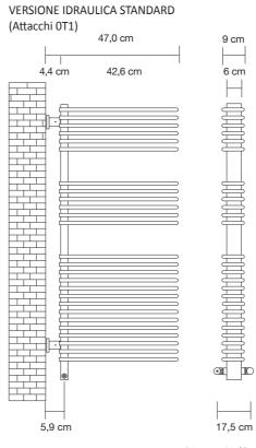
Interasse attacchi con misure riferite alle valvole Tubes
